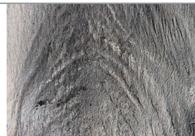
Fatigue Fracture (20x)
